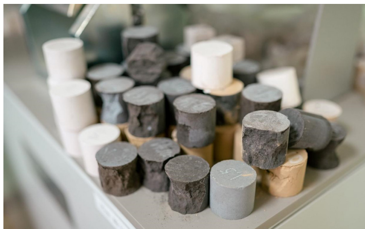
Рисунок 1. Образцы строительных стеновых изделий из побочных продуктов и отходов промышленности – фосфогипса и отходов переработки диабазовых горных пород.
